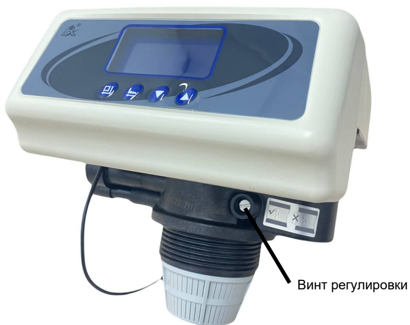
Рисунок 4 – Расположение винта регулировки остаточной жесткости
